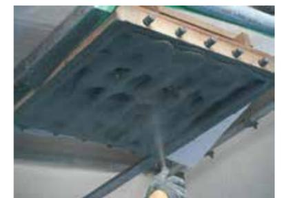
●鉄筋背面への充填性試験
