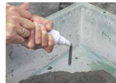
●チクソトロピー性簡易評価試験
